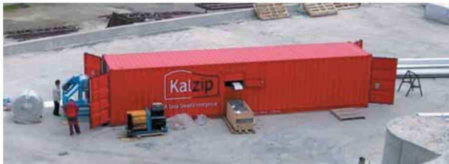
Мобильная производственная установка Kalzip
