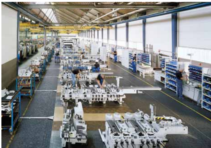
Конвейер в монтажном цехе 1 концерна WEINIG: колыбель успешных строгально-калевочных станков Unimat, Hydromat и Powermat
