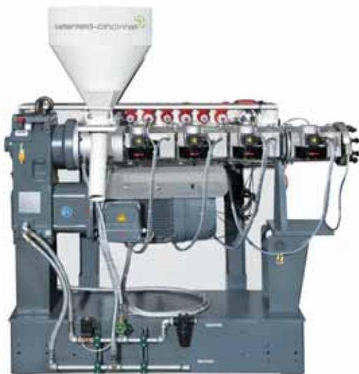
Вид экструдера «alpha 45» сзади. Компактный редуктор помогает экономить еще больше места.
