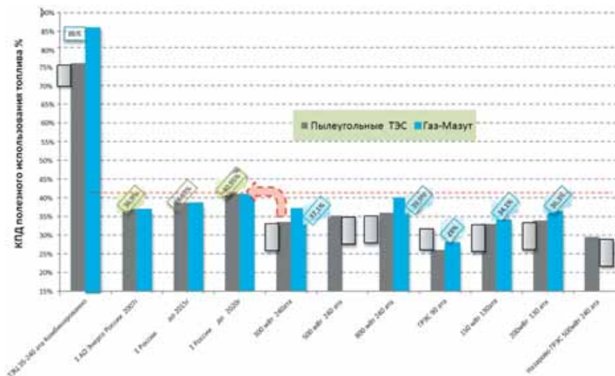
Рис. 4. Скрытое перекрестное субсидирование топливом показателей «Федеральной электроэнергетики» за счет коммунальных потребителей сбросного тепла турбин ТЭЦ (данные ОРГРЭС, 2007 г.)
