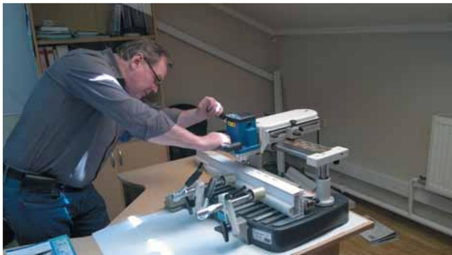
Станок для фрезерования отверстий внутрипрофильной вентиляции
