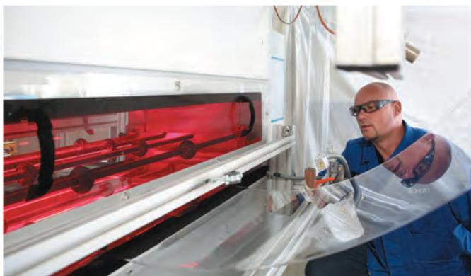
SCHOTT производит ультратонкое стекло по технологии «down draw». При этом стекло непрерывно подается через сопло вниз, на конвейер и в плавильную ванну, далее оно наматывается в рулоны для дальнейшей переработки (фото: SCHOTT)
