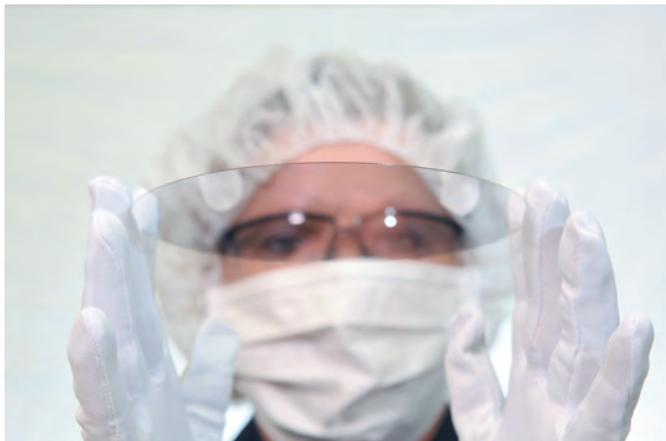
В соответствии с пожеланиями заказчиков SCHOTT производит ультратонкое стекло, как в листовом варианте, так и в виде пластин (см. фото). В данном случае используется бесщелочное алюминий-кремниевое стекло, маркировки AF 32® есо, либо слабощелочное боросиликатное стекло маркировки D 263® есо, обе разновидности уже производятся в соответствии с экологичными технологиями (фото: SCHOTT)
