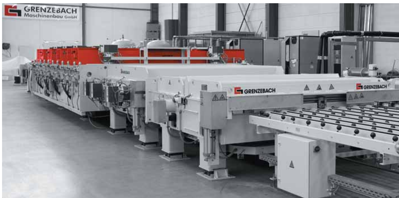
Предложения от компании Grenzebach поставка под ключ линии PVD по нанесению покрытия на стекло размером до 2600 x 2200 мм Фото: Grenzebach
