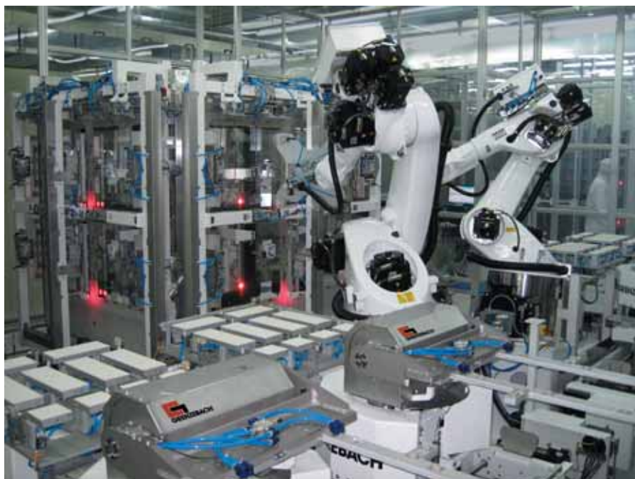
Роботы Grenzbach используемого для загрузки и выгрузки стекла при нанесении вертикального покрытия Фото: Grenzbach
