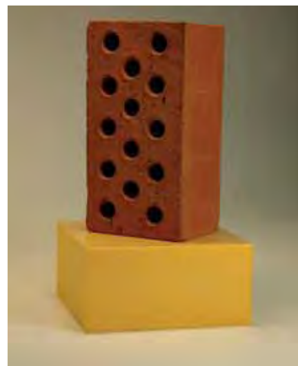
Фоторяд 3: сравнение прочностных показателей минеральной ваты и ПЕНОПЛЭКС® (фасадный кирпич, вес — 1 кг)
