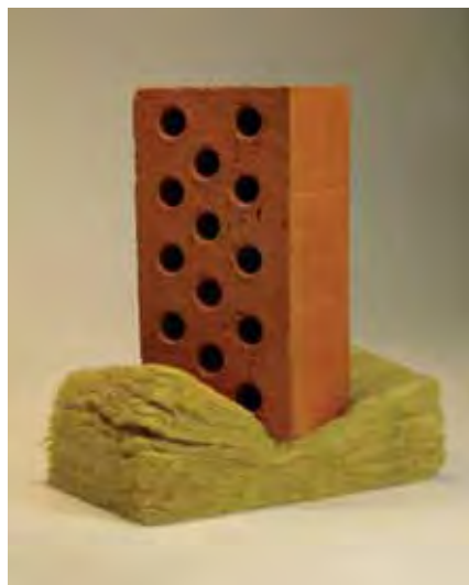
Фоторяд 3: сравнение прочностных показателей минеральной ваты и ПЕНОПЛЭКС® (фасадный кирпич, вес — 1 кг)
